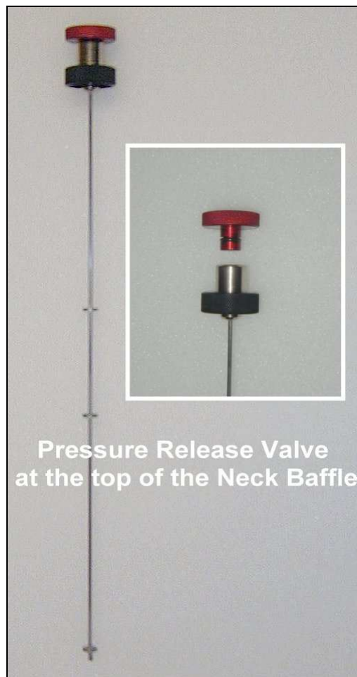
Photo 3.2. Cryostat neck baffle
